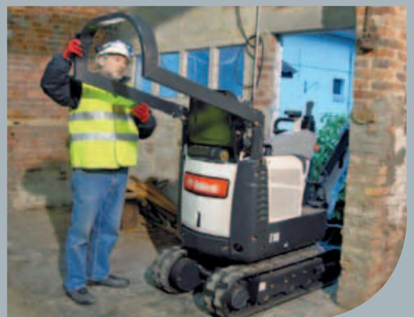
Beide Modelle sind mit einem umklappbaren TOPS-Sicherheitsbügel ausgerüstet.
