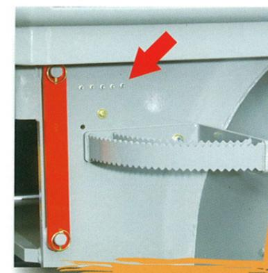
Die zentrale Leiste im Aufstiegsbereich ermöglicht die bequeme Schmierung des gesamten Hinterwagens
