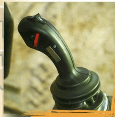
Elektrohdraulische Vorsteuerung über Multifunktions-Joystick
