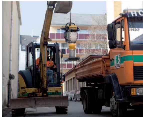
Stabile Einpunktaufhängung zum sicheren Transport.
