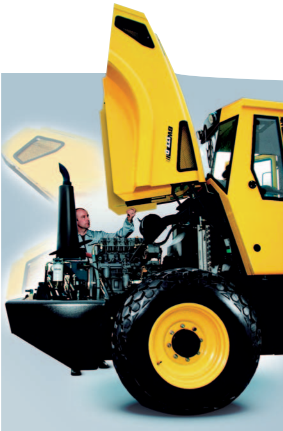
Sichere Sache: Die wenigen Wartungspunkte sind vom Boden zu erreichen. Die Haube lässt sich leicht von Hand öffnen.
