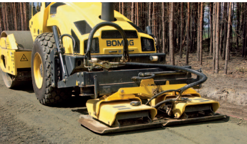
Für eine perfekte Oberfläche: BW 213 DH-4 mit Anbauplatten.
