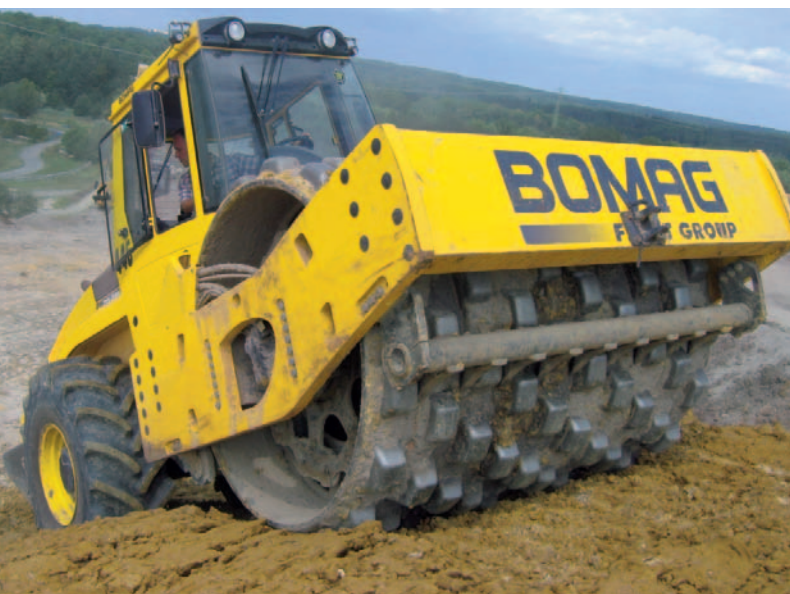
DH-Antrieb - bis zu 63% Steigfähigkeit. Hier eine BW 219 PDH-4 im Dammbau.
