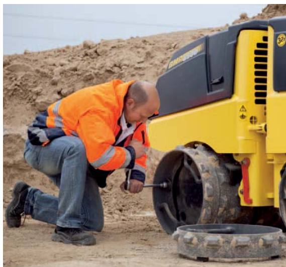
Optionale Bandagenverbreiterungen für schnelles Wechseln der Arbeitsbreite bei schmalen und breiten Gräben.
