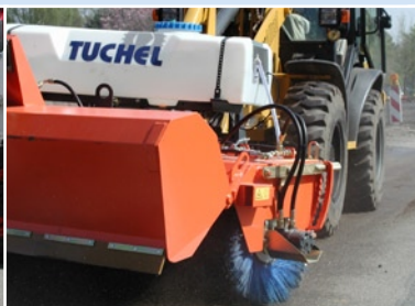
Staubbinding durch Wassersprüh-einrichtung, Freikehrmodus serienmäßig
